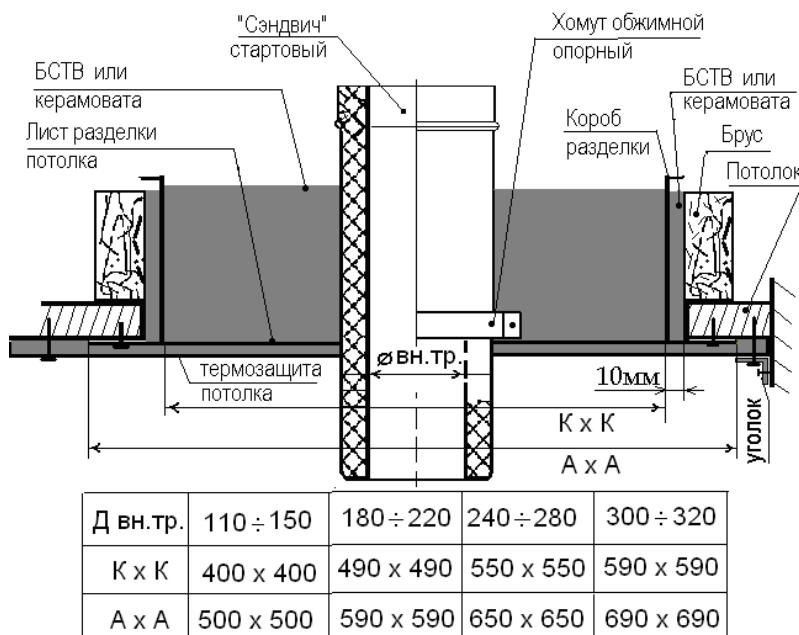
Рис. 4. Схема установки потолочной разделки.
