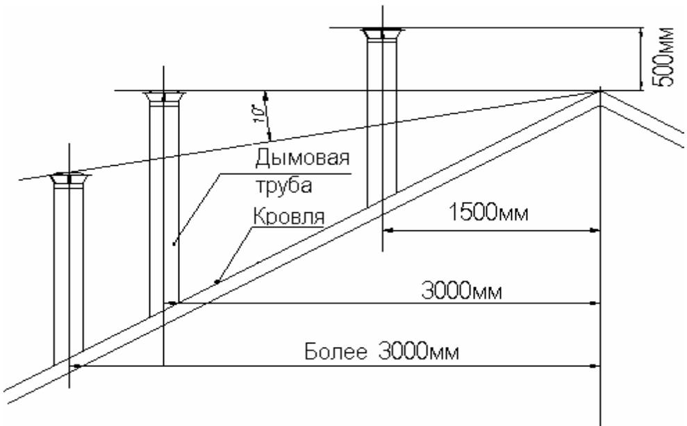
Рис.3. Определение высоты наружной части дымового канала.
