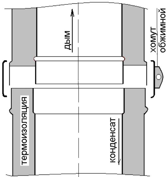
Рис.5. Схема сборки «сэндвич-труб».
